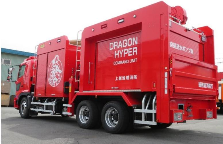
水中ポンプ1基を積載し、0.3MPaで毎分4,000リットルの水を吸い上げることができます。
